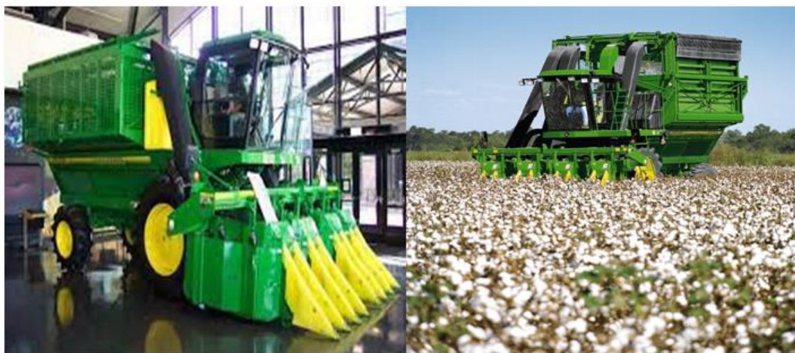
Сурет 1 - «Джон Дир» фирмасының 9970 модельді мақта жинайтын комбайны
